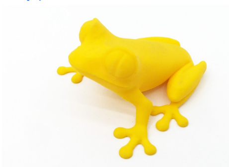
Obr. 20 - 50 mikronová žába se často používá pro srovnání kvality tisku
